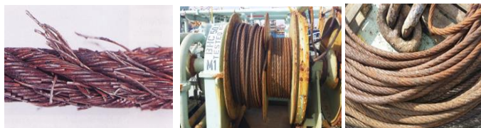
نمونه‌هایی از نگهداری غیرصحيح ماشین‌آلات
