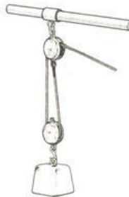
ترکیب بلوک با دو قرقره با قسمت ثابت بسته شده به قرقره بالا
