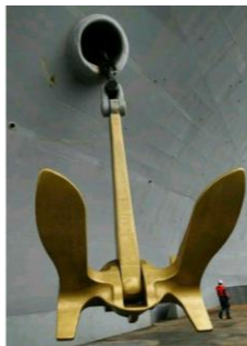
لنگر کشتی از نوع لنگرهای بدون دسته (استوکلس)
