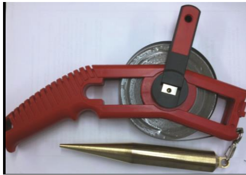
اندازه‌گیری سطح مخزن (ULLAGING FLOAT)
