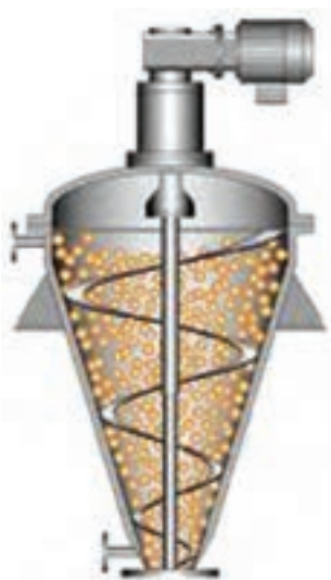
شکل ۱۰-۱۱ - مخلوط‌کن ماریچ عمودی
