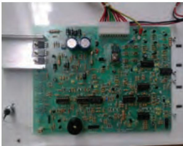
شکل ۱-۲۹ مدار الکترونیکی یک نمونه تابلو اعلام حریق
