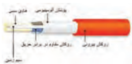
شکل ۱-۲۴ قسمت‌های مختلف یک کابل اعلام حریق
