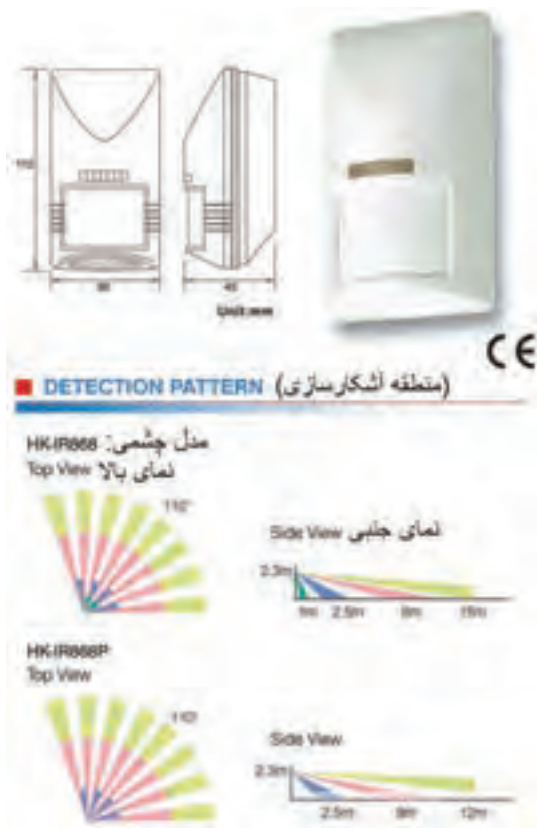
شکل ۱۲-۲ منطقه دید دو نوع چشمی با لنز استاندارد
