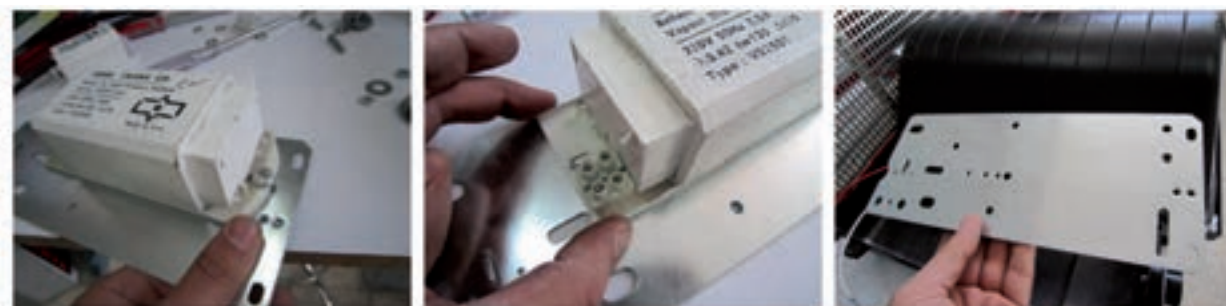
شکل ۲-۳۹ - نحوه نصب بالاست در نورافکن
