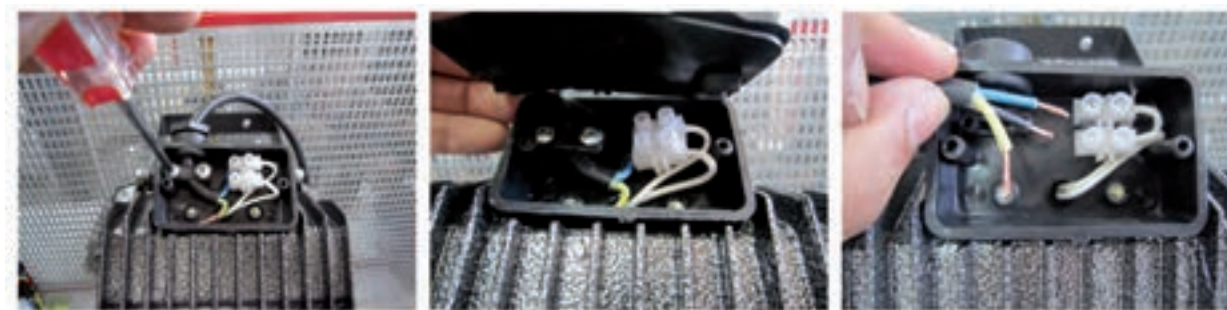
شکل ۲-۲۵ - سیم کشی در جعبه اتصالات
