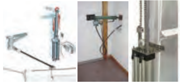
شکل ۴-۲ سیستم‌های در اتوماتیک پنوماتیک
