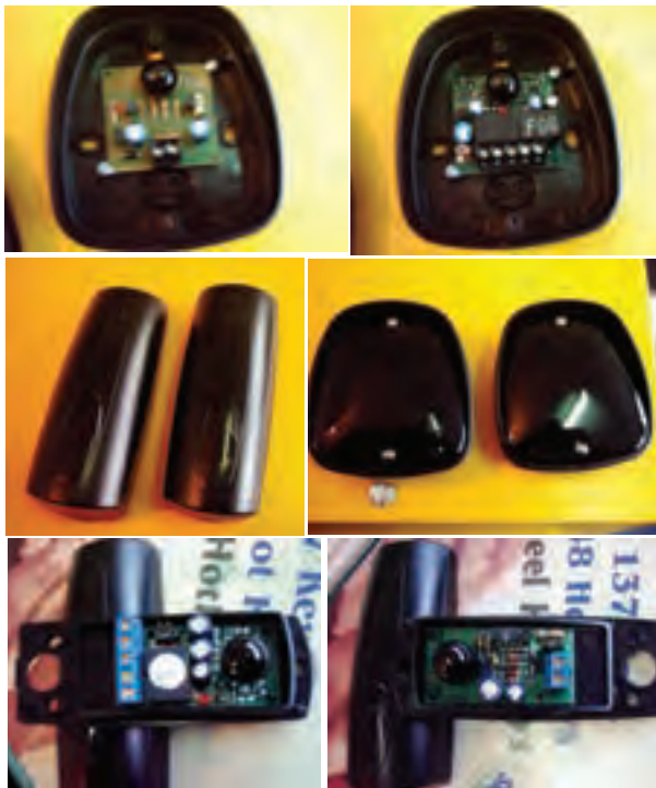
شکل ۴-۲۱ دو نوع چشمی مادون قرمز مورد استفاده در درهای اتوماتیک ریلی و لولایی
