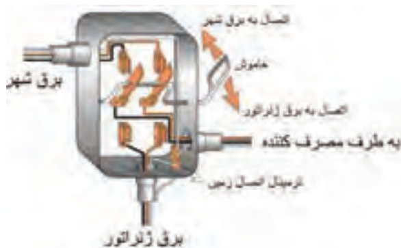
شکل ۱۷-۵ کلید تعویض دو طرفه تک فاز
