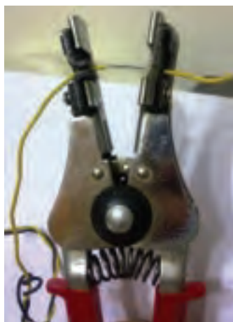
شکل (۱-۴) برداشتن روکش سیم‌ها
