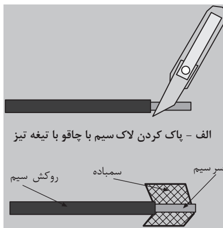
شکل (۱-۵) پاک کردن لاک سیم با سمباده
