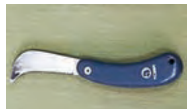
شکل (۱-۳۰) چاقوی مخصوص روپوش برداری کابل
