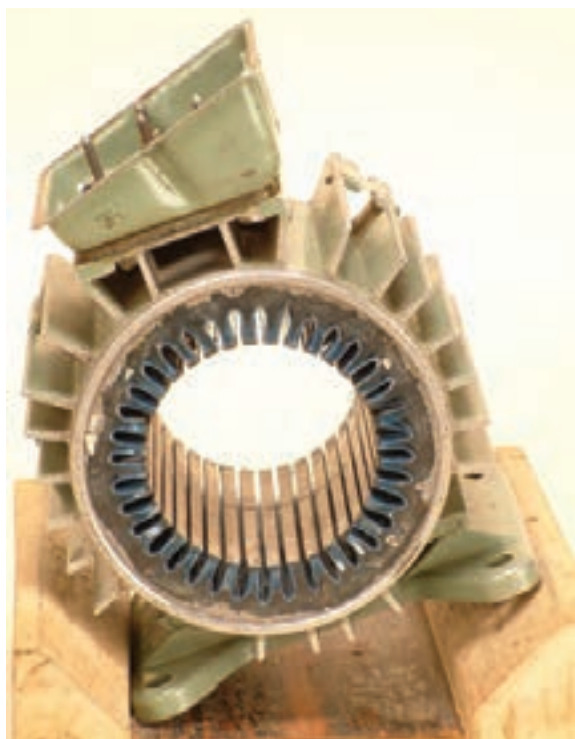
شکل ۱۳-۲- انتخاب شیار شروع و مسیر کلاف‌گذاری
