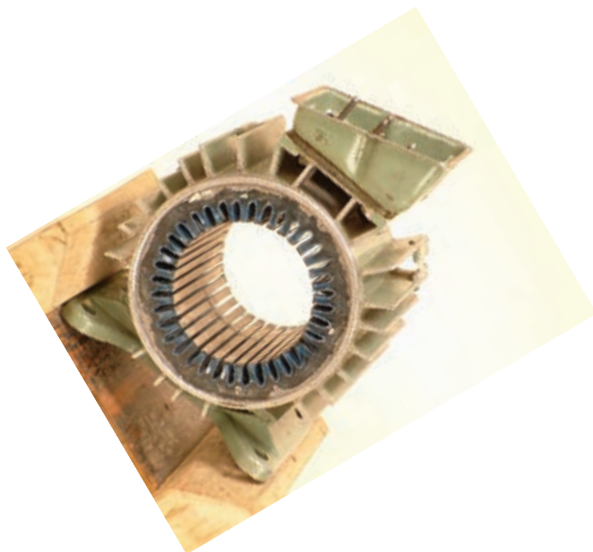
شکل ۱۲-۲- پوسته موتور سه فاز ۳۶ شیار
