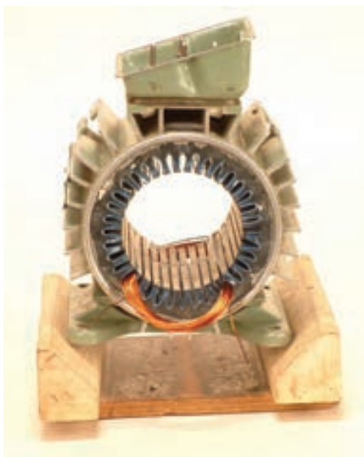
شکل ۲-۱۱- استقرار کامل یک کلاف در داخل شیارهای استاتور
