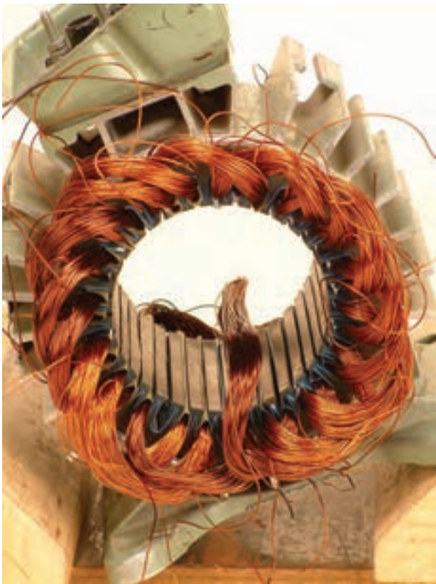
شکل (۲-۳۸-ب) بازوی شماره ۱ پس از برگردانیدن آن به داخل شیار شماره ۱
