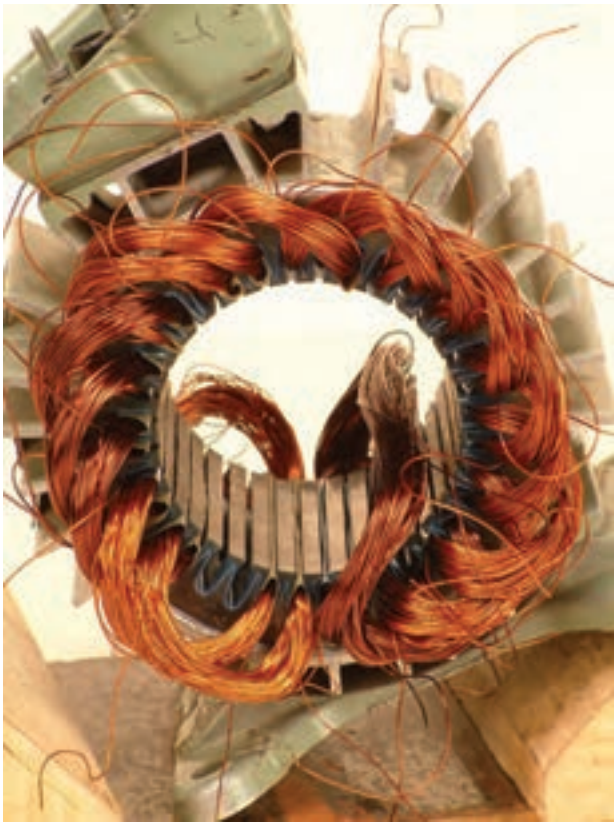
۱۵- بازوی شماره ۱ را به شیار شماره ۱ برگردانید (شکل ۲-۳۸).
