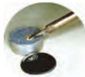
د- تمیز کردن سر هویه
