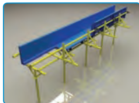
شکل ۳-۳۷- استفاده از قالب فلزی برای اجرای تیر بتنی
