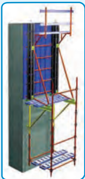
شکل ۲۰-۳- قالب رونده (لغزنده)
