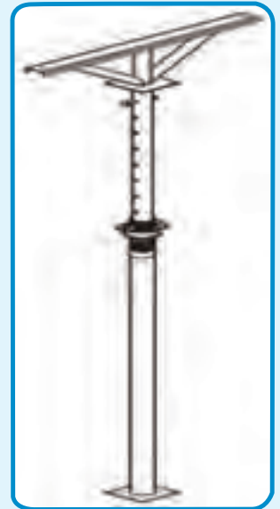
شکل ۳-۲۲- شمع فلزی کامل تنظیم ارتفاع
