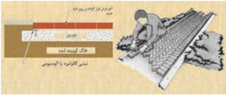
شکل ۳-۵۷ نحوه اجرای رویه نهایی معابر با آجر سفالی - نقشه جزئیات اجرایی پیاده رو
