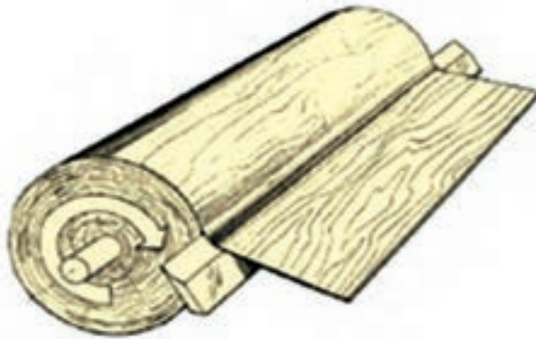
شکل ۱-۲۰ تهیه روکش به روش لوله‌بری
