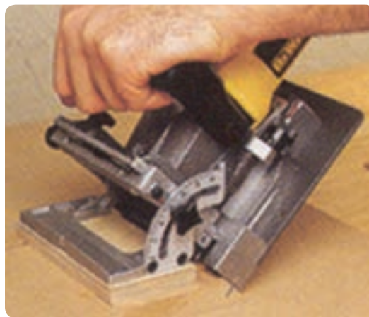
شکل ۲-۹۰ شیارزنی با زاویه ۴۵ درجه
