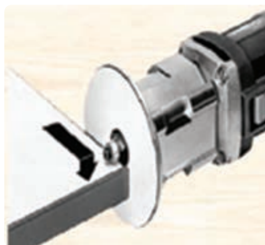
شکل ۱۵۵-۲ پرداخت لبه‌های اضافی روکش مصنوعی
