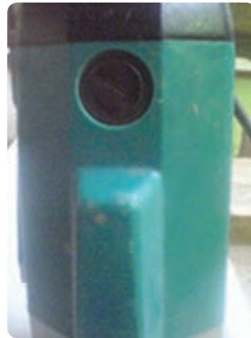
شکل ۲-۶۷ محفظه قرارگیری زغال کلکتور
