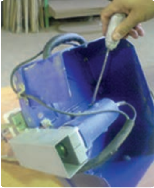
شکل ۱۱۷-۲ تصویر از زیر دستگاه گرفته شده است که در پوش پیچی زغال کلکتور جهت بازدید باز می‌شود
