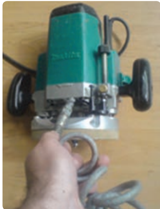
شکل ۲-۷۱ بادگیری دستگاه پس از پایان کار
