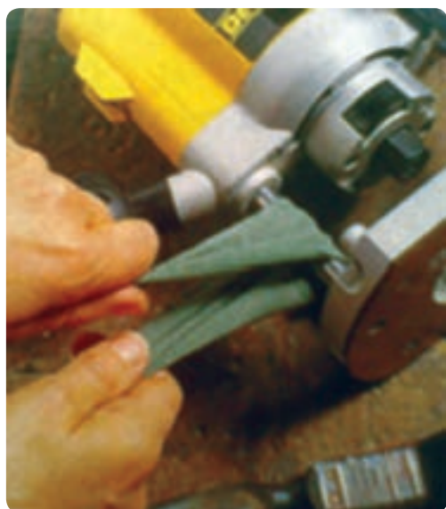
شکل ۶۶-۲ تمیز کردن میله‌های کشویی اورفرز
