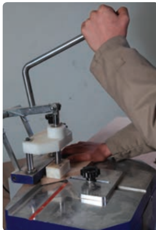
شکل ۲-۱۱۲ برش با زاویه ۴۵ درجه
