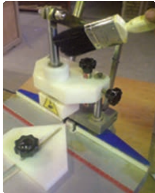
شکل ۱۱۶-۲ تمیز کردن مفصل‌های حرکتی ماشین دم چلچله‌زن
