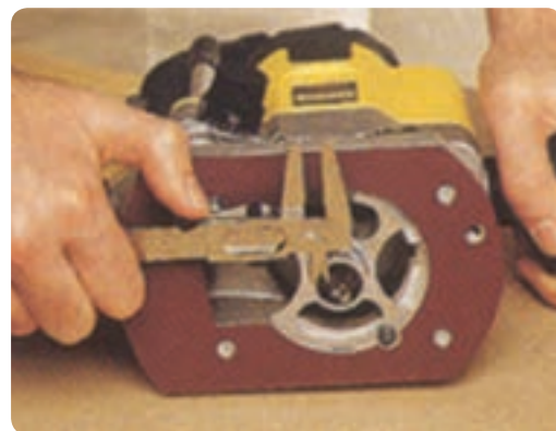
شکل ۲-۶۸ اندازه‌گیری قطر شفت فرز
