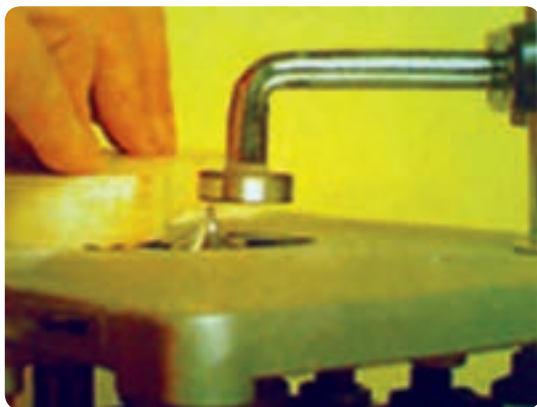
شکل ۶۵-۲ بلبرینگ هدایت برای قطعات قوس‌دار
