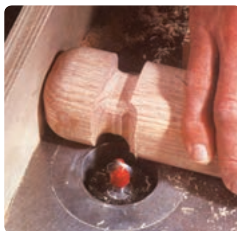
شکل ۶۴-۲ فرز زدن گلوبی یک پایه
