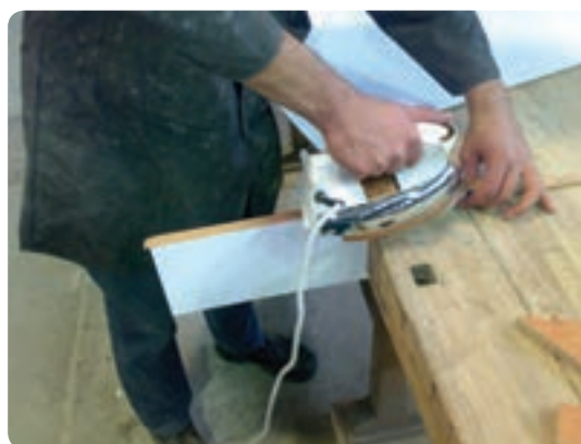
شکل ۱۴۷- اتوکشی نوار روکش لبه‌چسبان
