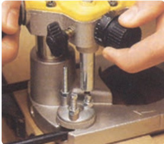
شکل ۲-۷۲ پیچ‌های تنظیم دستگاه
