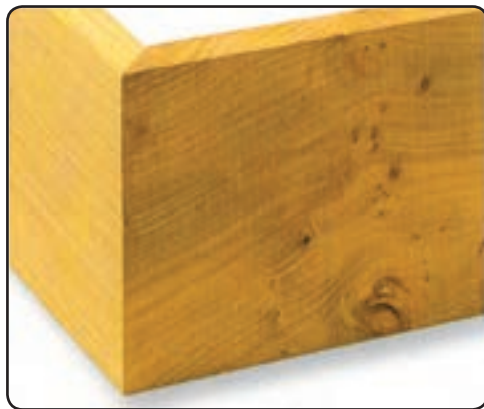
شکل ۴-۱۲۶ اتصال دم چلچله دورو مخفی
