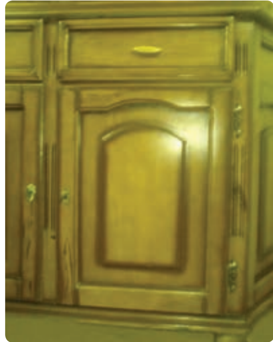
شکل ۶-۲۰ در قاب تنک‌های روئسته دو راه‌دار
