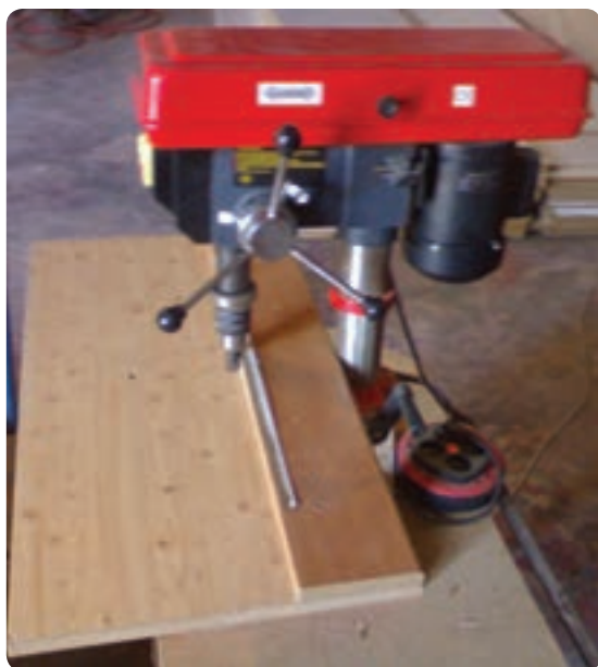
شکل ۶-۷۰- دریل ستونی همراه با شابلون جهت سوراخ‌کاری
