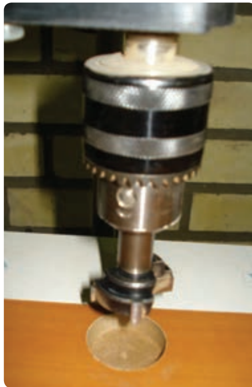
شکل ۶-۷۱ مته کابینت جهت سوراخ کردن جای لولا
