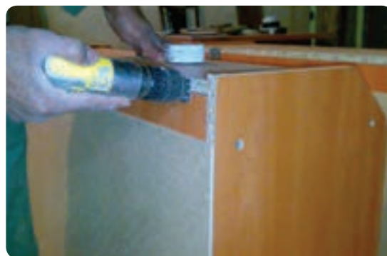
شکل ۱۳۱-۶ نصب لولای محفظه جاواکسی
