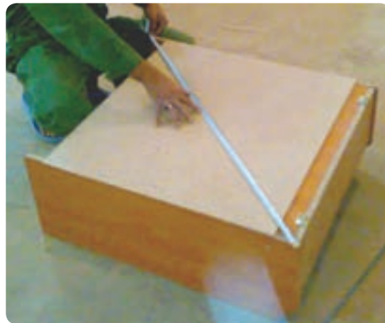
شکل ۱۳۰-۶ کنترل دويدگی کابینت
