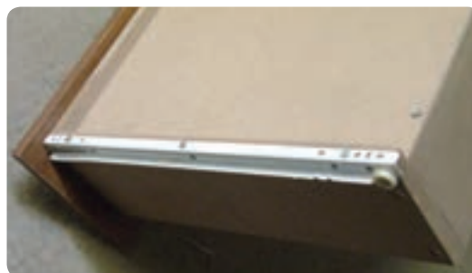
شکل ۶-۱۱۲ نصب ریل مکانیکی در زیر بدنه جعبه
