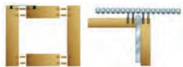
شکل ۲-۱۶- الف- روش ساخت اتصال قاب ساده، به وسیله دوپل زن ماشینی
