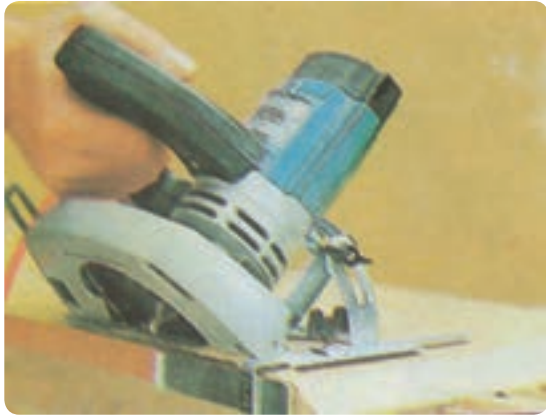
شکل ۳۷-۲ برش تحت زاویه به وسیله گونیای دستگاه
