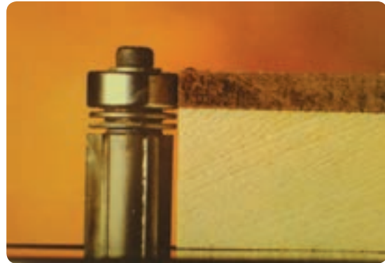
شکل ۲-۴۹ فرز زدن لبه صفحه کار با بلبرینگ در پایین صفحه
