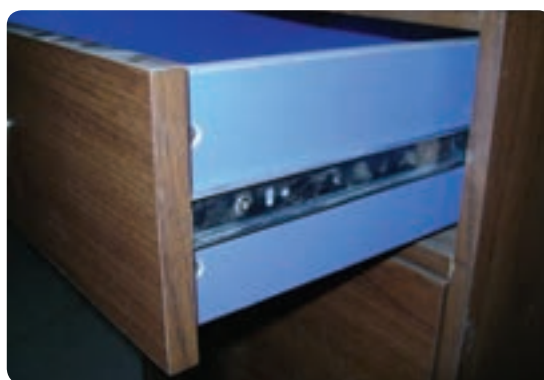
شکل ۵۶-۶ ریل مکانیکی نصب شده در بدنه جعبه
