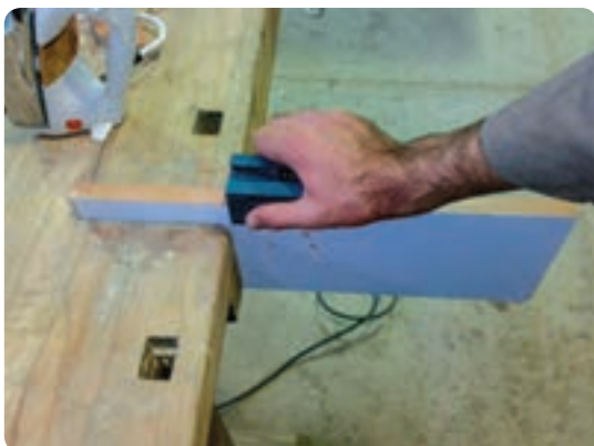
شکل ۱۵۶-۲ رنده پرداخت لبه نوار روکش لبه چسبان
