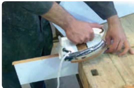
شکل ۸۱-۶ لبه چسبانی روکش مصنوعی با اتو
