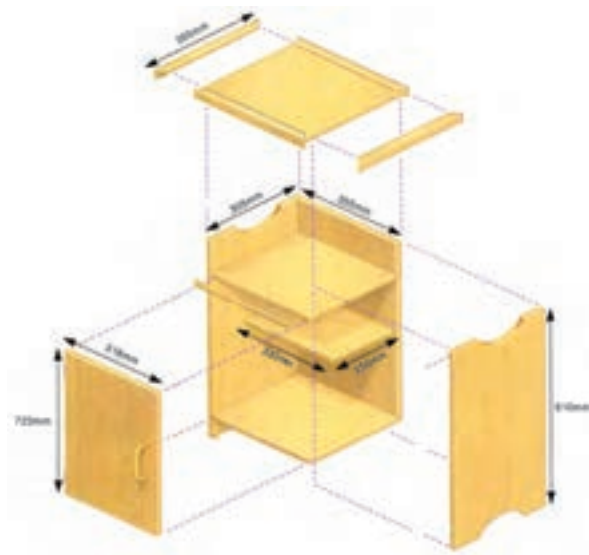
شکل ۳۵-۸ نقشه مونتاز قطعات کابینت
