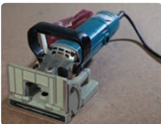
شکل ۲-۹۵ اتصال زن بیسکویتی با گونیا و موقعیت شاخص روی گونیا
