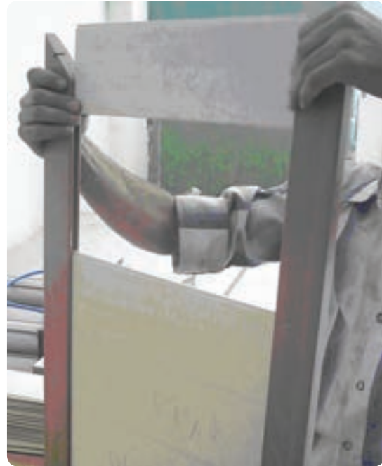
شکل ۶-۹۵ مونتاژ در قابدار با تنگ لته‌ای
