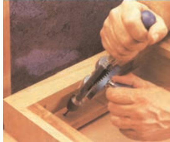
شکل ۱۶۱-۶ مونتاژ صفحه میز به قاب دراور
