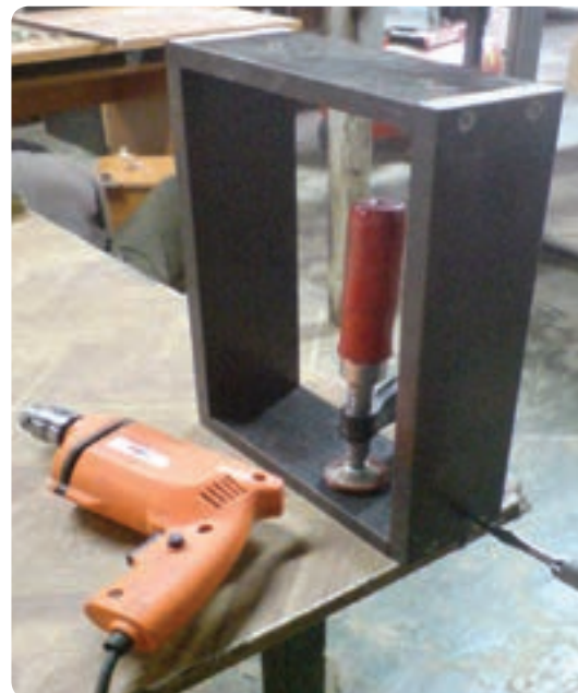
شکل ۶-۱۰۸ مونتاژ دستی جعبه کشو
