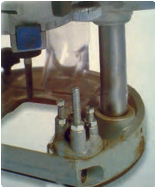
شکل ۲-۴۴ پیچ‌های تنظیم ارتفاع اور فرز دستی برقی
