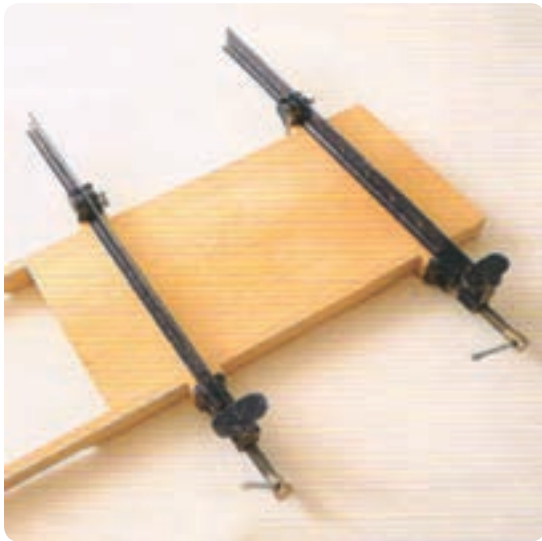
شکل ۵۹-۸ مونتاژ بدنه به پایه
