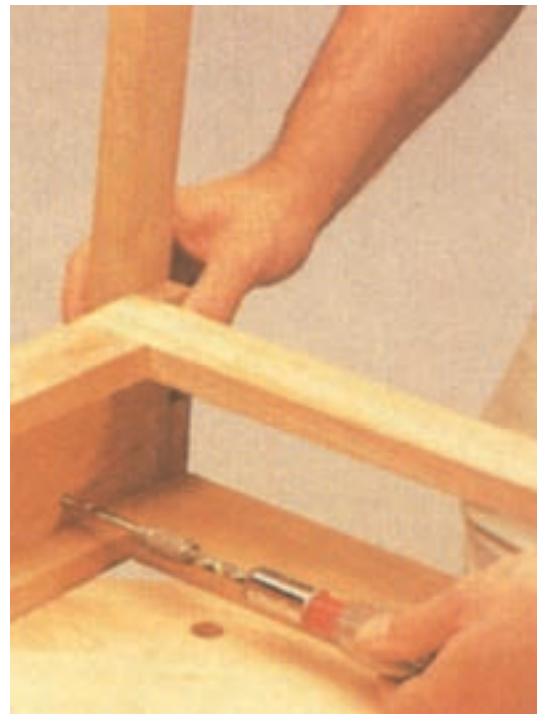
شکل ۶-۱۵۹ اتصال قاب دراور به قاب کناری
