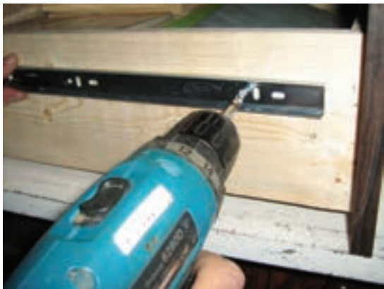
شکل ۷-۳۶ نصب ریل بر روی بدنه‌ی کشو
