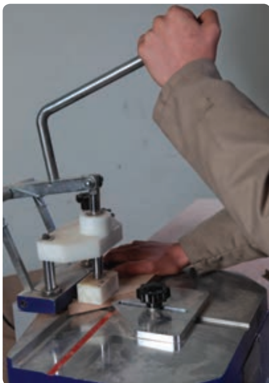
شکل ۶-۹۳ اتصال دم چلچله زن پروفیل
