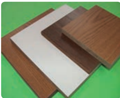
شکل ۱-۲۵ تخته خرده‌چوب روکش شده با پی‌وی‌سی
