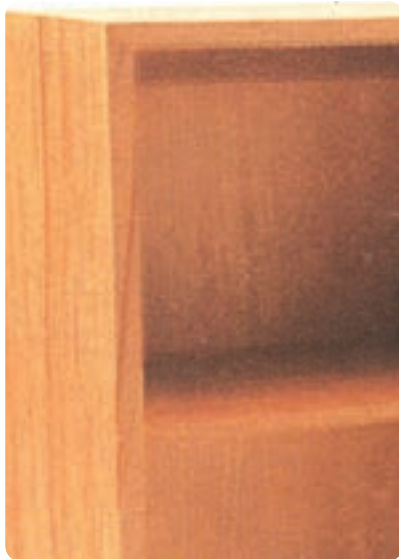
شکل ۶-۷ سقف و کف همرو با بدنه
