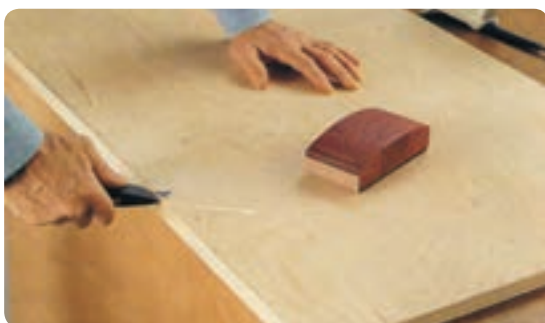
شکل ۷۷-۸ برداخت لبه های اضافی روکش لبه چسبان
