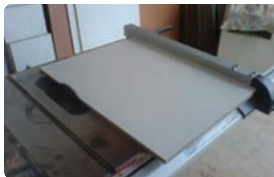
شکل ۶-۶۷- برش صفحات با اره مجموعه‌ای
