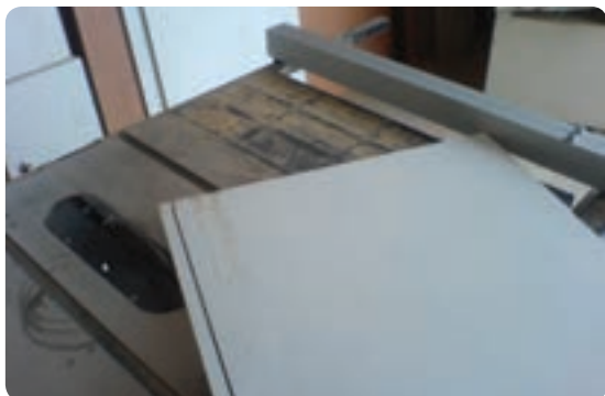
شکل ۶-۶۹- کنشکاف زدن جهت پشت بند
