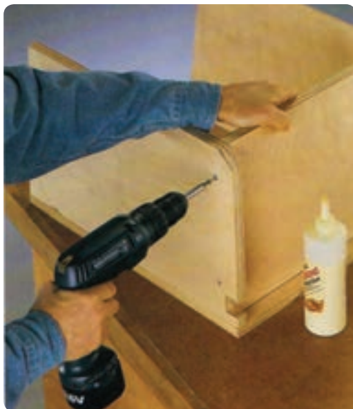
شکل ۱-۴۱ کاربرد تخته چندلایه در ساخت مصنوعات چوبی
