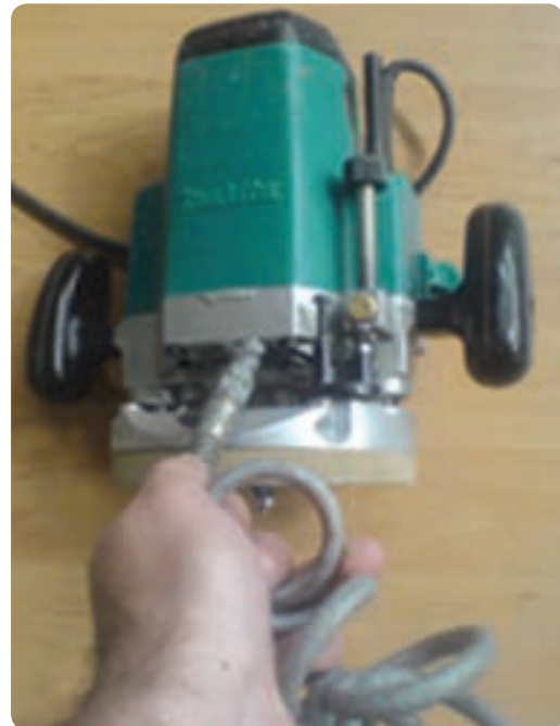
شکل ۲-۷۱ بادگیری دستگاه پس از پایان کار
