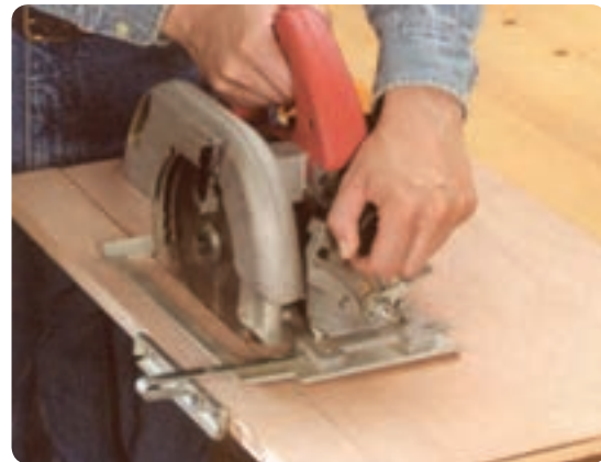
شکل ۲-۲۲ برش عرضی با گونیای ماشین
