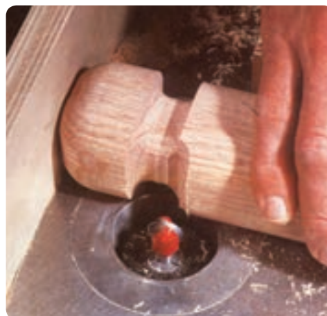
شکل ۶۴-۲ فرز زدن گلوبی یک پایه
