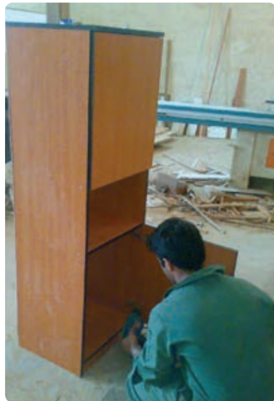
شکل ۱۲۲-۶ نصب در به کمد با لولا کابینتی فنردار
