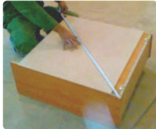
شکل ۱۳۰-۶ کنترل دويدگی کابینت
