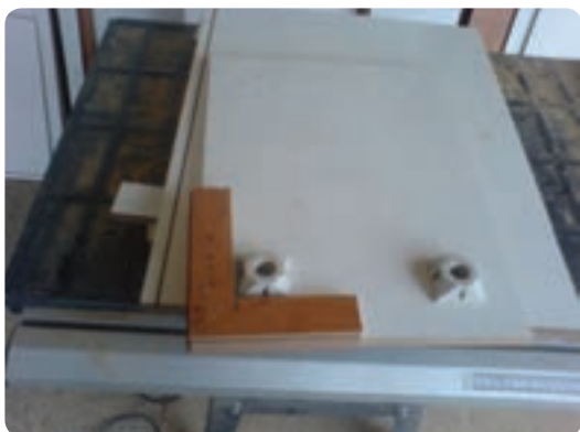
شکل ۶-۱۱۴ شابلون گونیایی جهت نصب پایه کابینت
