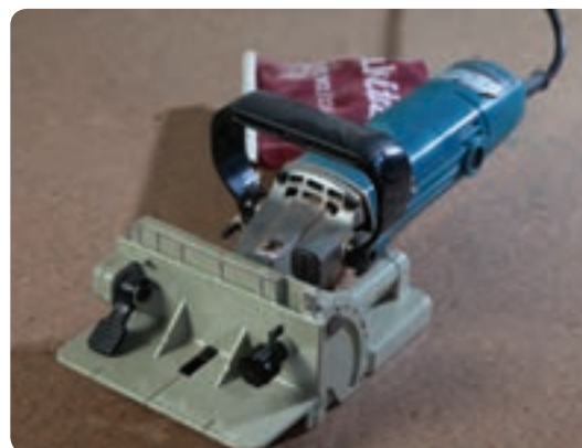
شکل ۲-۹۳ کیسه جمع آوری خاک اره در ماشین اتصال زن بیسکویتی
