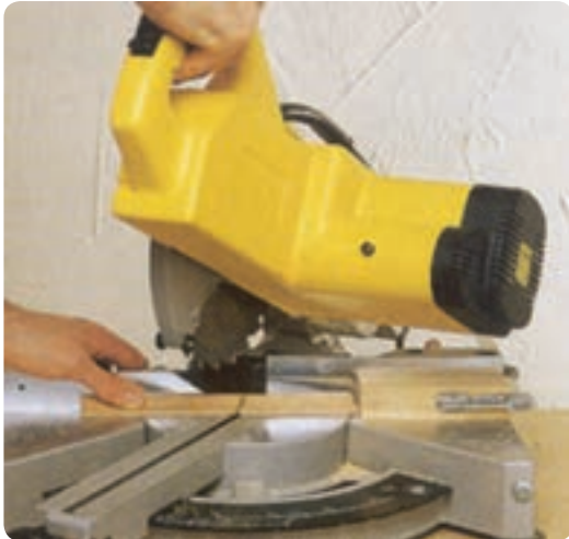
شکل ۲-۱۲- برش قائم با اره گرد فارسی بر
