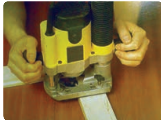
شکل ۵۹-۲ فرزکاری داخل قاب
