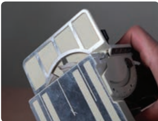
شکل ۲-۹۴ اتصال زن بیسکویتی بدون گونیا
