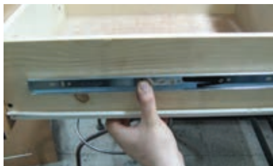
شکل ۷-۳۵ تعیین محل ریل بر روی بدنه کشو
