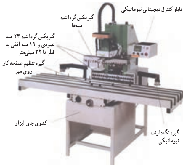
ماشین سوراخ‌زنی و لولازنی دیجیتالی نیوماتیک
