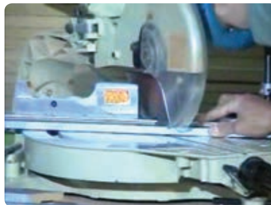
شکل ۶-۹۲ برش پروفیل‌ها با دستگاه فارسی بر
