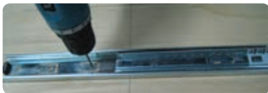
شکل ۷-۳۳ سوراخ‌کاری محل استقرار ریل روی بدنه فایل
