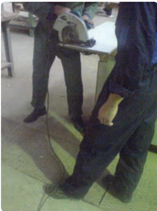
شکل ۲۷-۲ سیم سیار در مسیر نباشد
