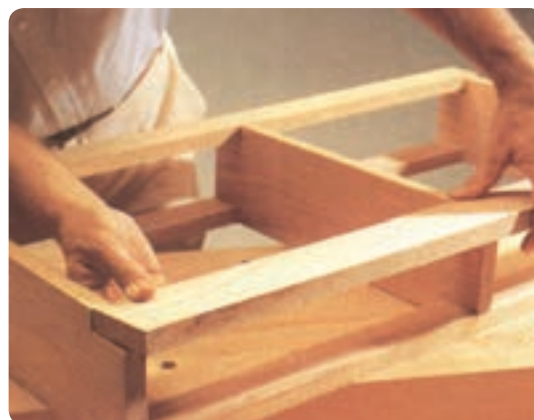
شکل ۶-۱۵۵ مونتاژ کلاف قاب دراور
