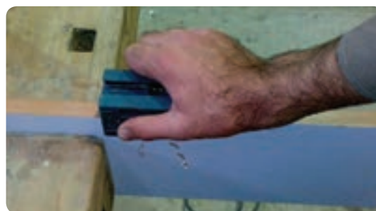
شکل ۸۲-۶ پرداخت لبه اضافی روکش
