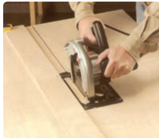
شکل ۲-۲۳ برش طولی با گونیای برراستی
