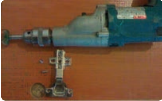
شکل ۱۲۸-۶ نصب لولای کابینت فنردار روی در کابینت
