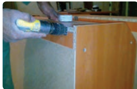
شکل ۱۳۱-۶ نصب لولای محفظه جاواکسی
