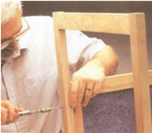
شکل ۶-۱۶۰ مونتاژ قاب پشت با قاب کناری
