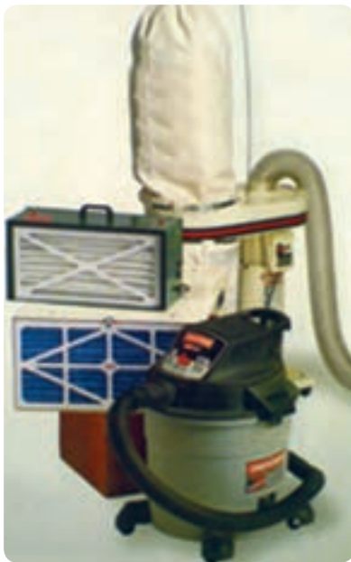
شکل ۲-۷۰ نمونه‌ای از مکنده‌های کارگاهی
