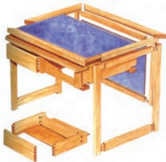
شکل ۶-۱۴۷ تصویر مجسم انفجاری مونتاژ
