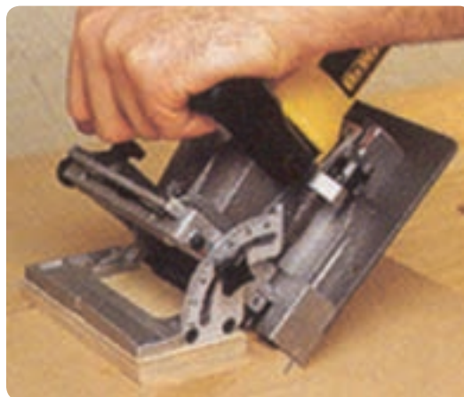
شکل ۲-۹۰ شیارزنی با زاویه ۴۵ درجه
