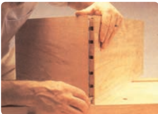
شکل ۶-۱۴۰ مونتاژ آزمایشی قبل از چسب زدن قطعات
