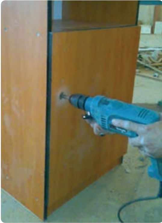
شکل ۱۲۳-۶ در آوردن جای قفل سوئیچی
