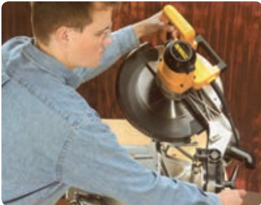
شکل ۲-۹ تنظیم زاویه چرخش اره گرد
