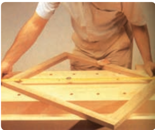
شکل ۱۵۰-۶ اطمینان از گونیایی قاب
