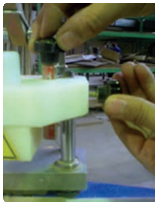
شکل ۲-۱۱۳ تنظیم عمق فرز جهت اتصال
