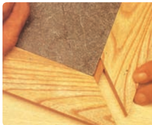
شکل ۶-۱۵۲ مونتاژ صفحه میز
