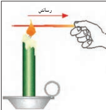
شکل ۳-۸- رسانش در یک میله فلزی
