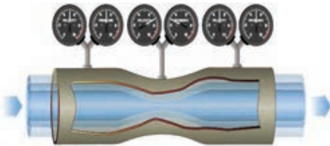
شکل ۳-۳۳- تغییرات فشار و سرعت در یک شیپوره
