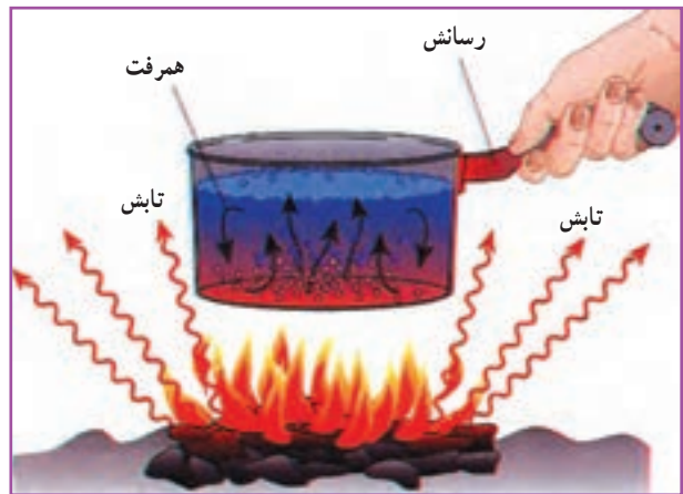
شکل ۳-۱۱- انتقال گرما به هر سه روش
