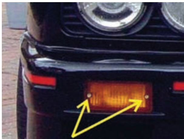
شکل ۱-۵۰ پیچ‌های اتصال تلق چراغ راهنما
