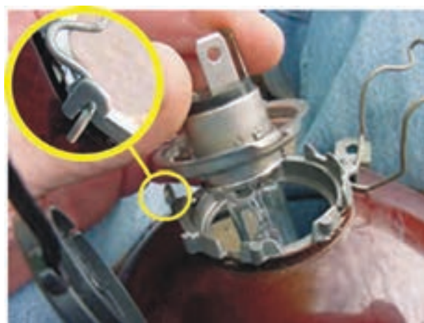
شکل ۱-۴۳- نحوه‌ی ثابت شدن لامپ درون کاسه‌ی چراغ
