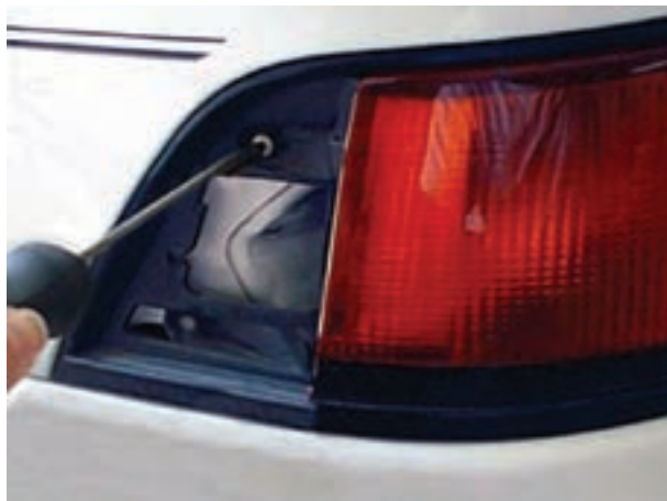
شکل ۱-۵۶- باز کردن پیچ‌های قاب چراغ
