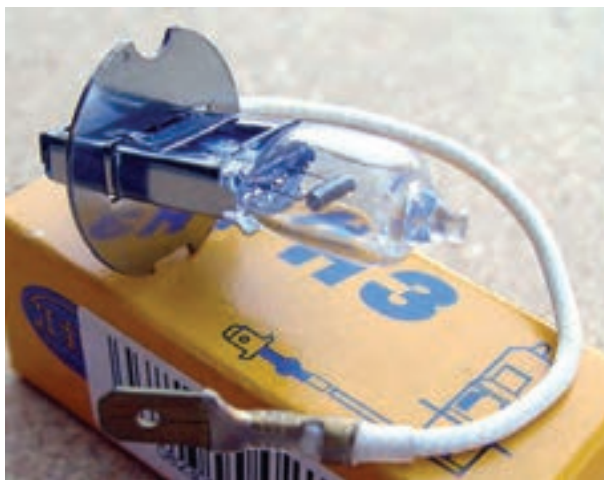
شکل ۱-۳۱- لامپ مورد استفاده در چراغ‌های مه‌شکن، نورافکن‌ها
