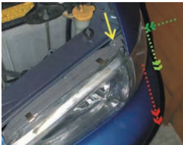
شکل ۱-۳۸- نحوه‌ی جداکردن چراغ جانبی روشنایی
