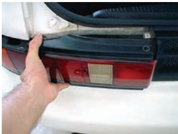
شکل ۱-۵۸- جدا کردن چراغ عقب از بدنه‌ی خودرو
