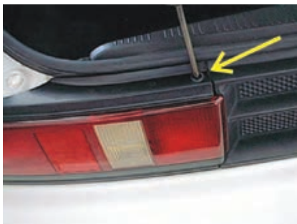
شکل ۱-۵۷- باز کردن پیچ روی قاب چراغ‌های عقب خودرو
