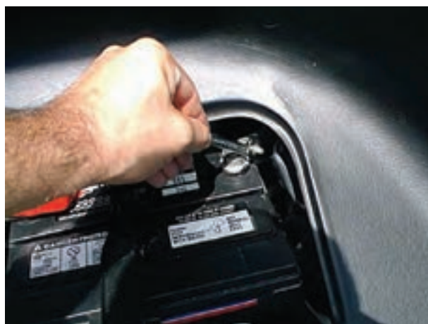
شکل ۱-۵۲ باز کردن بست ترمینال منفی باتری
