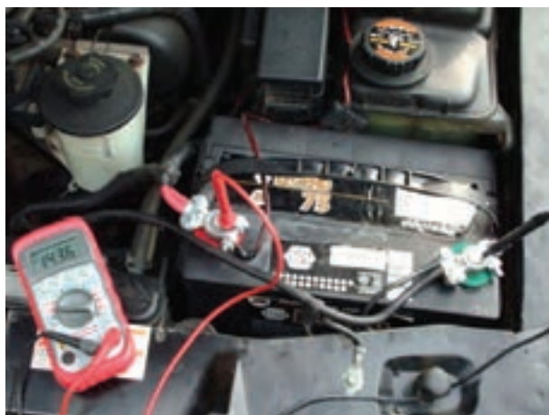
شکل ۱-۶۶ — اندازه گیری ولتاژ باتری
