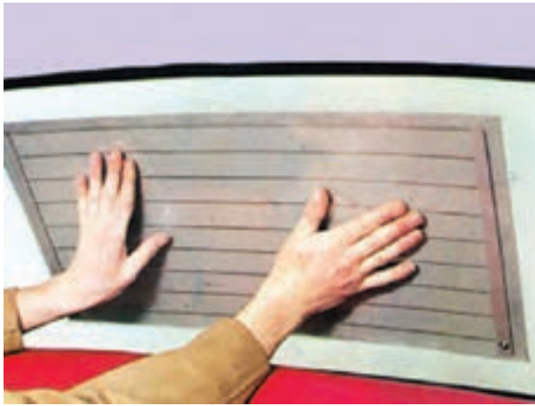
شکل ۳-۹- نحوه چسباندن المنت حرارتی
