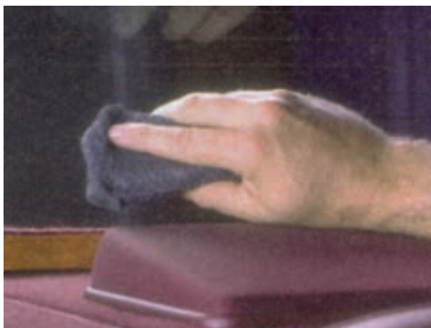
شکل ۲۲-۳- تمیز کردن محل قطع شده‌ی المنت حرارتی
