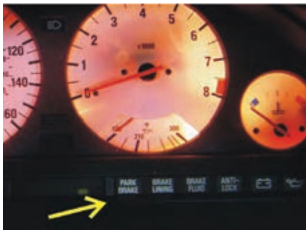
شکل ۲۰۵-۱- چراغ‌های اخطار سیستم ترمز
