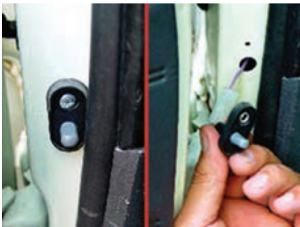
شکل ۱۹۲-۱- باز کردن سوئیچ لای در
