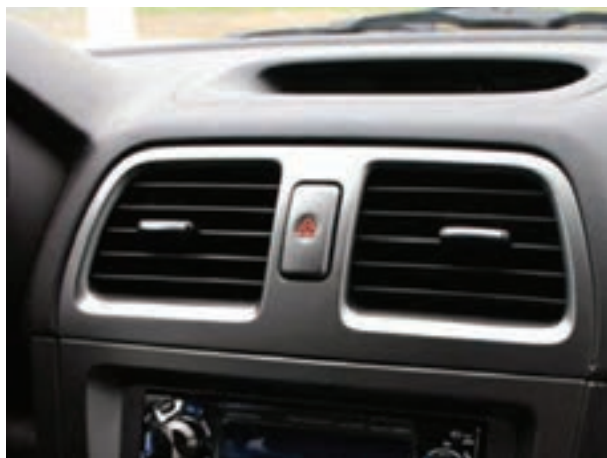
شکل ۱-۱۷۳- سوئیچ فلاشر یک‌نوع خودرو
