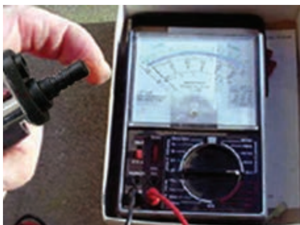
شکل ۱۹۶-۱- آزمایش سوئیچ لای در
