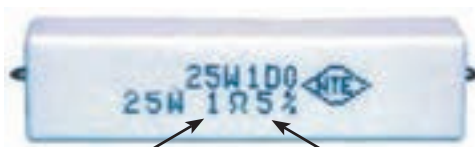
تولرانس 5\% درصد مقدار مقاومت یک اهم
