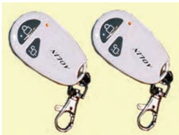
شکل ۲-۶- یک نوع ریموت کنترل قفل مرکزی
