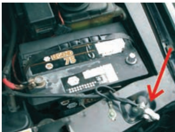
شکل ۱۵-۶- جدا کردن بست کابل اتصال بدنه‌ی باتری
