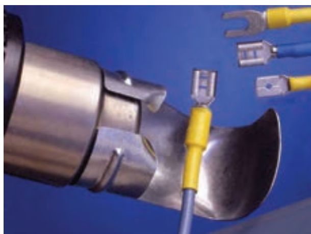
شکل ۶-۳۱- عایق کاری محل اتصال سیم و سرسیم
