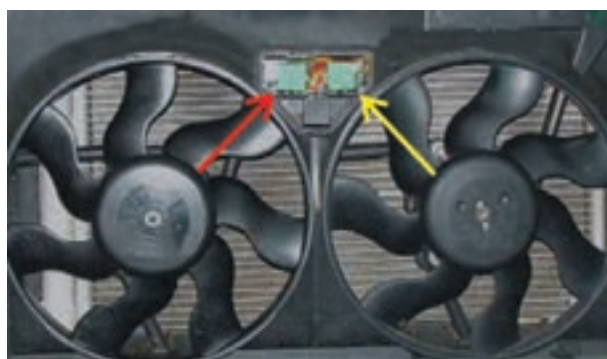
شکل ۱۱-۶- رله ی فن ها
