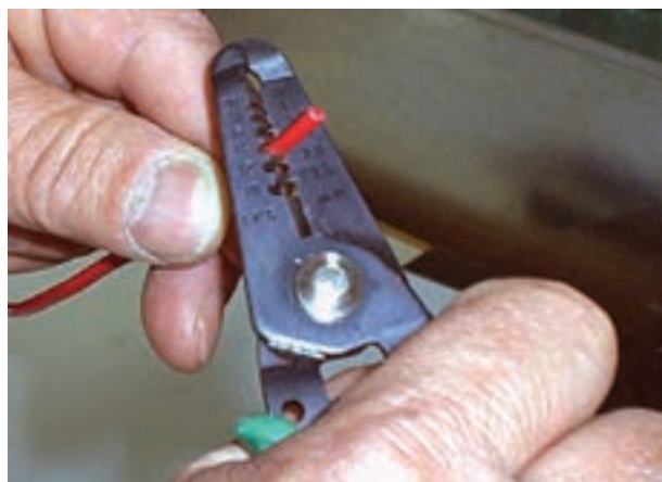
شکل ۶-۳۰- جدا کردن عایق سیم
