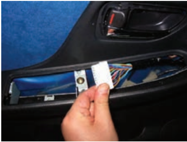
شکل ۱۸۵-۲- سوکت اتصال دسته سیم به سوئیچ‌ها
