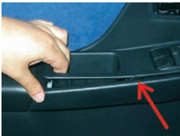
شکل ۱۸۳-۲- خارج نمودن قاب سوئیچ‌ها
