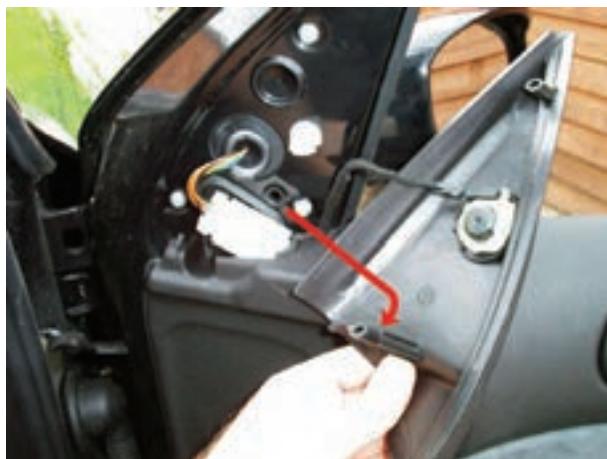
شکل ۱۶۵-۲ خارهای روی قاب و محل نصب آن
