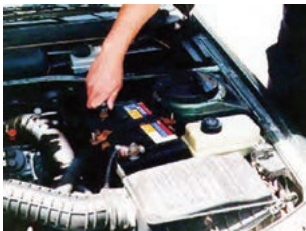
شکل ۱۶۴-۲ بازکردن کابل اتصال بدنه‌ی باتری
