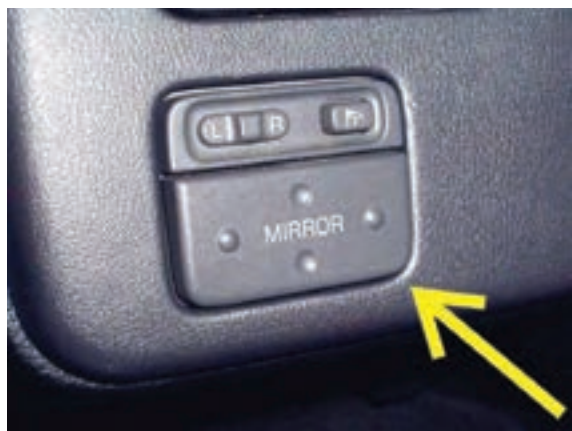
الف- سوئیچ آینه‌های جانبی یک نوع خودرو
