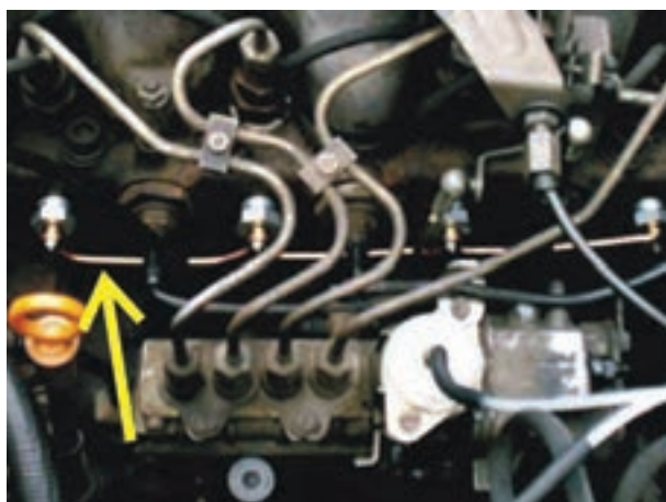
شکل ۷-۱۳- اتصال سری شمع گرم کن
