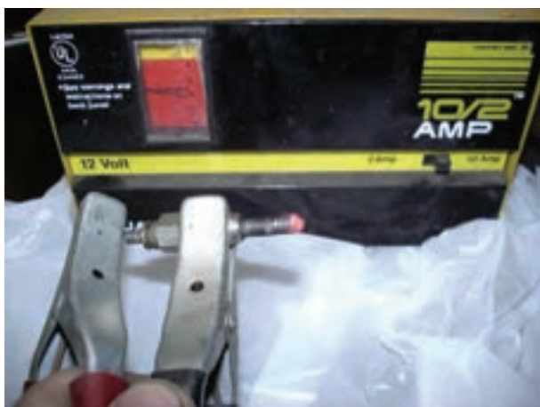
شکل ۱۶-۱۳- آزمایش سالم بودن المنت حرارتی شمع گرم کن
