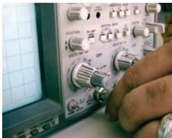
شکل ۱۱۴-۲ نحوه‌ی اتصال BNC به اسیلوسکوپ
