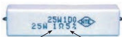
تولرانس 5\% درصد مقدار مقاومت یک اهم
