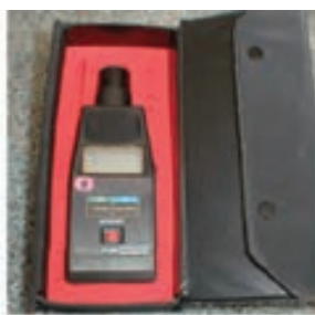
دورسنج دیجیتالی با محرک مکانیکی
