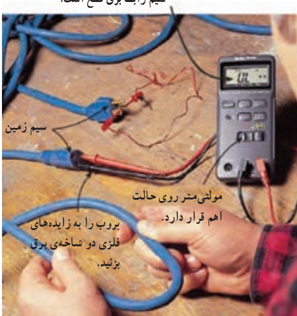
شکل ۲-۸۰ - آزمایش سیم رابط برق دستگاه.
