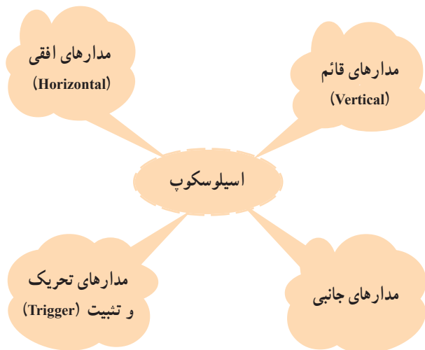
شکل ۱۲۰-۲- مدارهای موجود در اسیلوسکوپ
