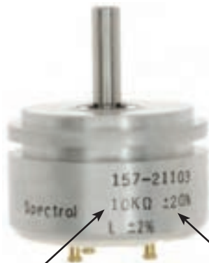
تولرانس 20\% درصد مقدار مقاومت 10\ \text{کیلو اهم} است
