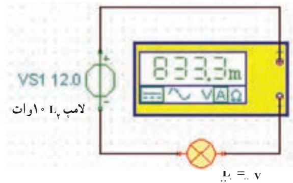
شکل ۹۵-۲- اندازه‌گیری جریان یک لامپ ۱۲ ولتی ۱۰ وات
