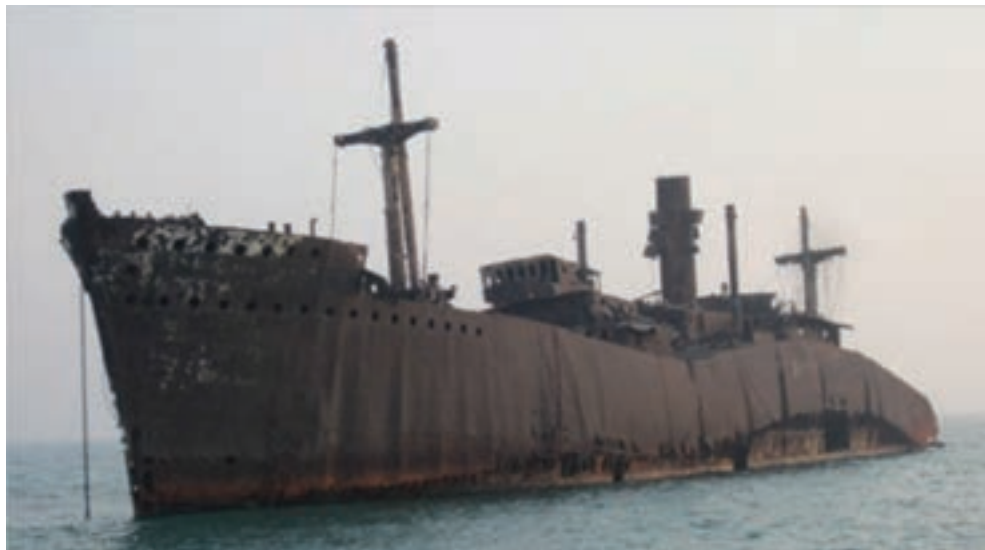
شکل ۱۴- به ترد شدن، خرد شدن و فروریختن فلزها بر اثر اکسایش، خوردگی گفته می‌شود.
