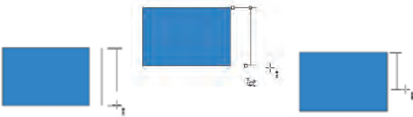
شکل ۳۷-۴ روش ثبت اندازه یک ضلع مستطیل توسط ابزار اندازه‌گیری
