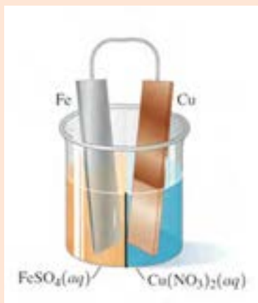
شکل ۵- سلول الکتروشیمیایی مس - آهن
