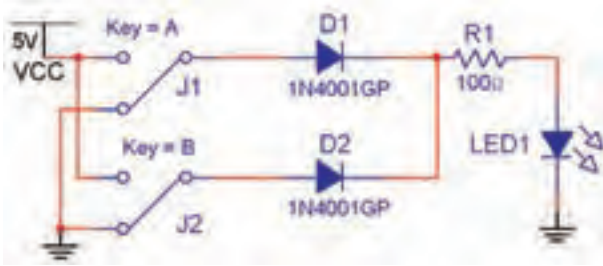
شکل ۱-۴ مدار دیودی گیت OR در حالتی که هر دو کلید A و B قطع است.
