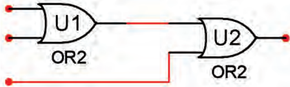
شکل ۲-۳۹ گیت OR با سه ورودی
