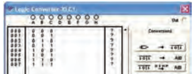
شکل ۲-۲۵ تنظیم جدول صحت روی دستگاه مبدل منطقی
