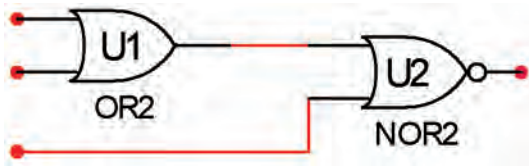
شکل ۲-۴۷ گیت NOR با سه ورودی
