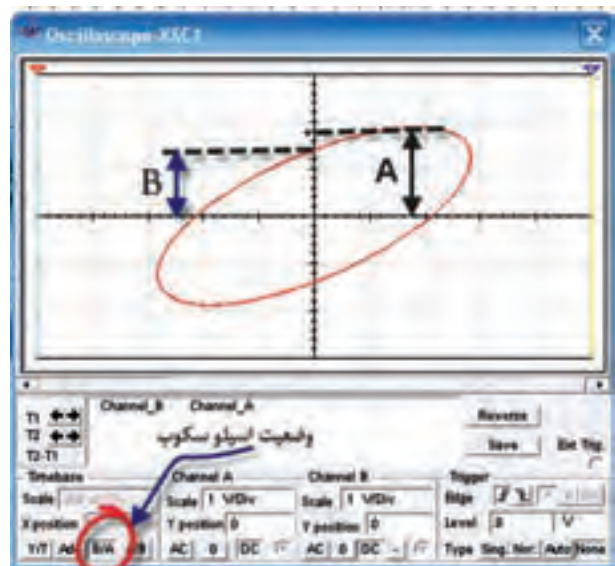
شکل ۲-۳ منحنی لیسازور مدار RL سری
