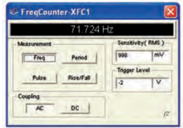
شکل ۸-۱۴ فرکانس اندازه‌گیری شده‌ی مدار نوسان‌ساز
