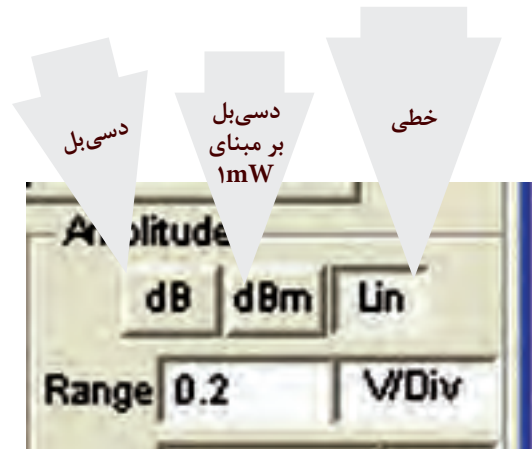
شکل ۷-۱ زبانه‌های مربوط به تنظیم دامنه
