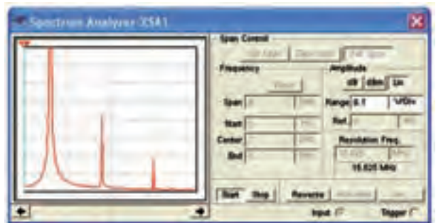
شکل ۱-۱۷ هارمونیک‌های موج مثلثی با فرکانس ۶۰۰ مگاهرتز
