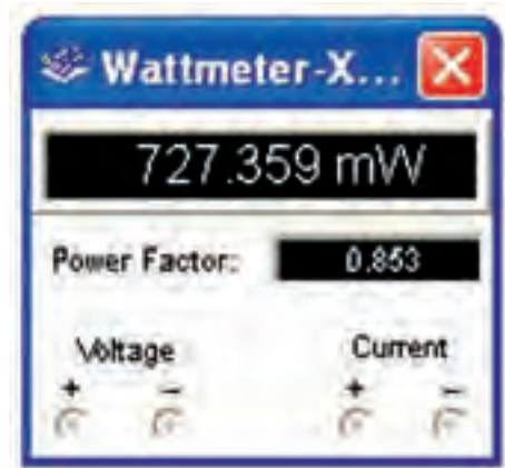
شکل ۳-۵ اندازه‌گیری توان مدار RLC سری
