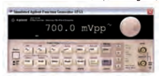
شکل ۳-۲ تنظیم دامنه در حالت AM
