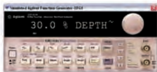
شکل ۵-۲ تنظیم درصد مدولاسیون در حالت AM
