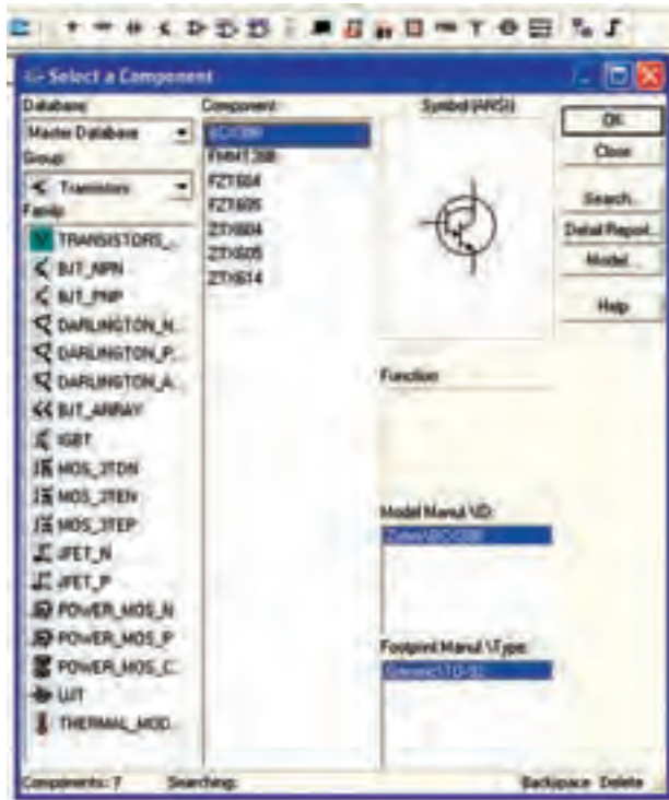
شکل ۴-۱۱ نحوه‌ی قراردادن ترانزیستور زوج دارلینگتون
