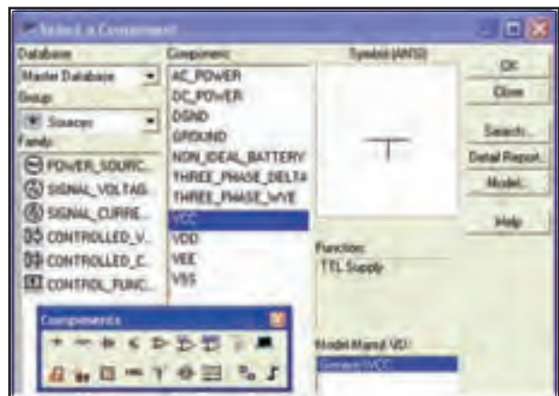
شکل ۱-۱ نحوه‌ی استفاده از منبع تغذیه‌ی ۵ ولتی ( V_{CC} )
