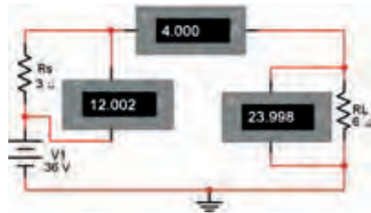
شکل ۱-۱۶ اندازه‌گیری مقادیر ولتاژ و جریان
