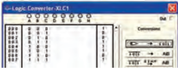
شکل ۲-۲۶ جدول صحت کامل شده روی دستگاه مبدل منطقی
