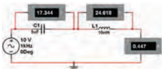
شکل ۴-۱-۱ اندازه‌گیری جریان و ولتاژ مدار LC سری
