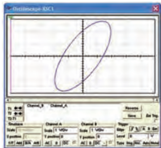
شکل ۳-۳ منحنی اختلاف فاز مدار RC سری
