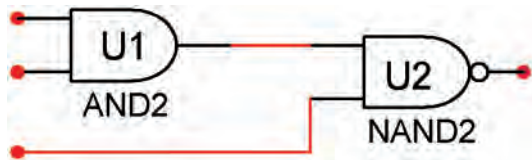
شکل ۲-۴۳ گیت NAND با سه ورودی
