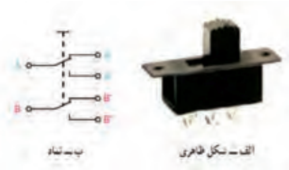
شکل ۶-۱ تصویر کلید تبدیل دوبل و نماد فنی آن
