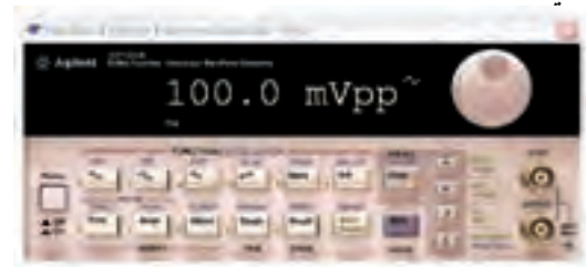
شکل ۲-۱۴ دستگاه فانکشن ژنراتور در حالت FM
