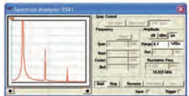
شکل ۱-۱۷ هارمونیک‌های موج مثلثی با فرکانس ۶۰۰ مگاهرتز
