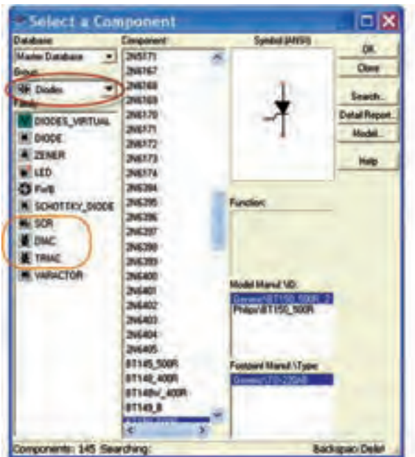
شکل ۱-۸ مسیر انتخاب قطعات الکترونیک صنعتی
