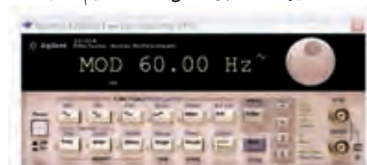
شکل ۲-۱۵ چگونگی تنظیم شاخص مدولاسیون در حالت FM
