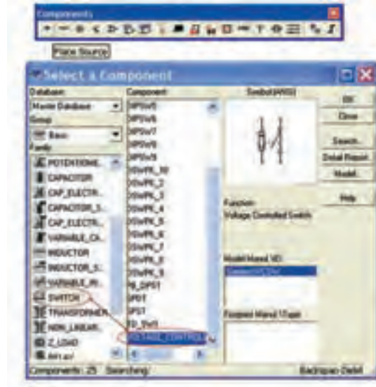
شکل ۶-۱۵ مسیر انتخاب کلید تابع ولتاژ
