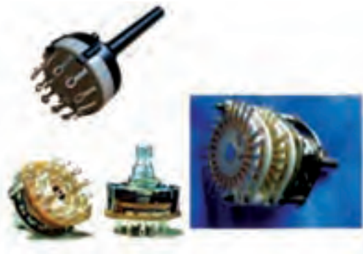
شکل ۶-۶ انواع کلیدهای چرخشی چند حالتی
