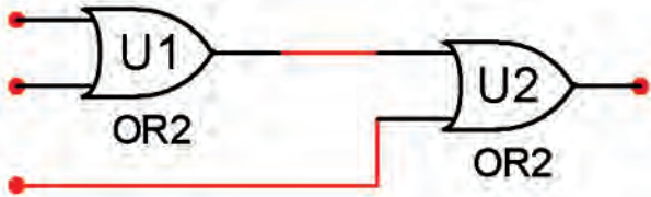
شکل ۲-۳۹ گیت OR با سه ورودی
