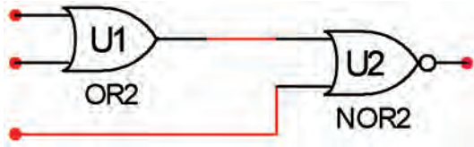
شکل ۲-۴۷ گیت NOR با سه ورودی
