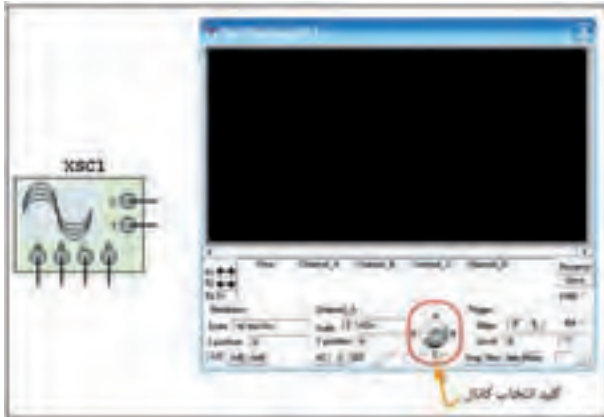
شکل ۱۶-۴ کلید انتخاب کانال در اسیلوسکوپ چهار کاناله
