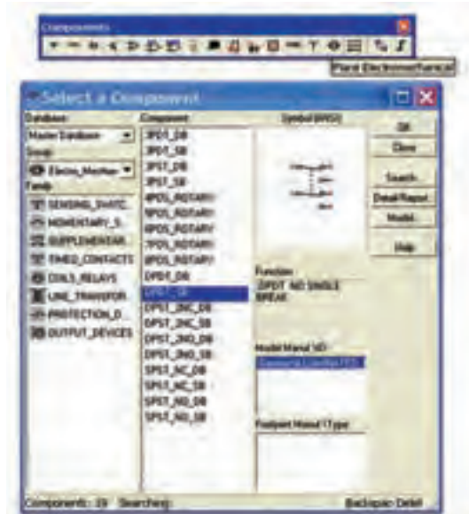
شکل ۶-۲ مسیر دسترسی به کلید باند ( کلید تبدیل)
