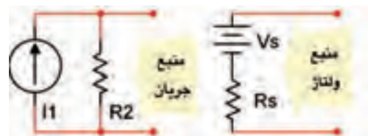
شکل ۱-۱۷ تبدیل منبع ولتاژ به منبع جریان
