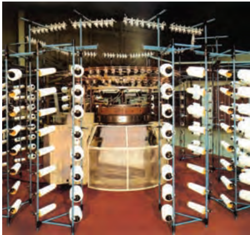
شکل ۳-۱۷- نمای یک ماشین گردباف مجهز به قفسه‌ی نخ جانبی
