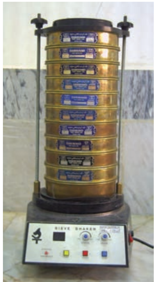
شکل ۱-۱- دستگاه لرزان آزمایشگاهی سری الک‌های استاندارد
