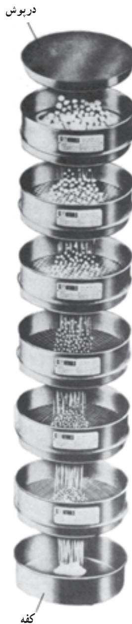
شکل ۱-۳- سری الک ها یا غربال های استاندارد شامل شش الک، یک درپوش و یک کفه
