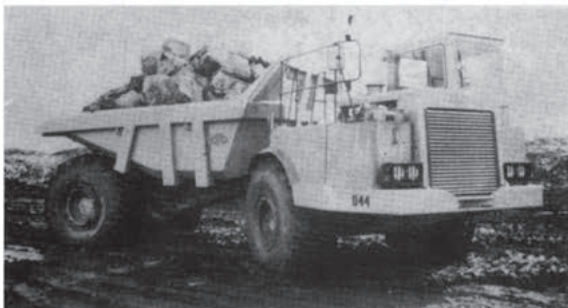
کامیون کمرشکن «دی - جی - بی» برای حمل سنگ و مواد معدنی در معادن
