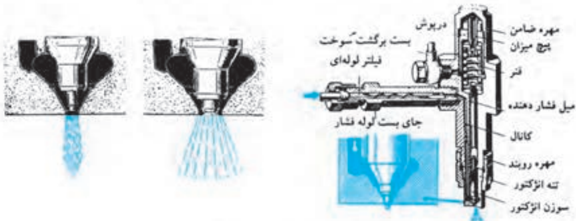
شکل ۹.۶: انژکتور (سوزن سوخت‌پاش)
