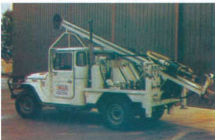
شکل ۲-۳: نمونه خودروهای حامل تجهیزات حفاری که با موتور بنزینی کار می‌کنند.
