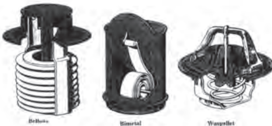
شکل ۶-۵ ساختمان انواع ترموستات (موتور شورولت)
