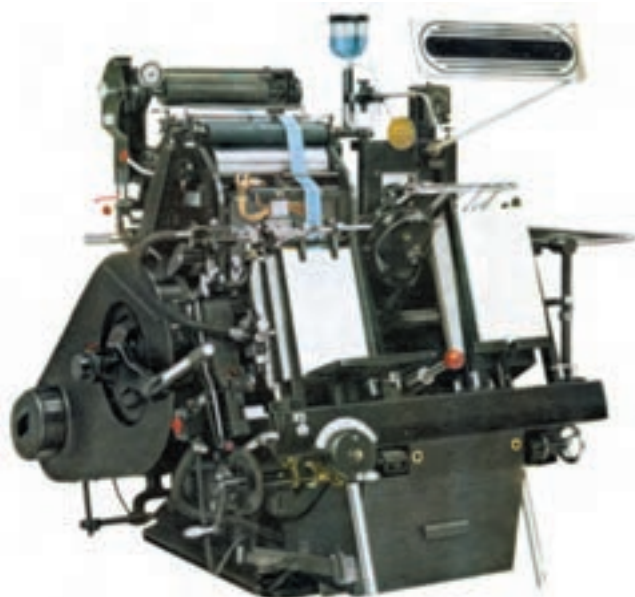
شکل ۲-۲- ماشین تیگل، سیستم بوستون معروف به ملخی
