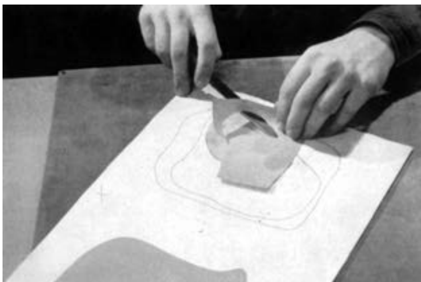
شکل ۲۴-۴- بریدن تکه‌ها جهت زیرسازی با چاقوی کاغذبری
