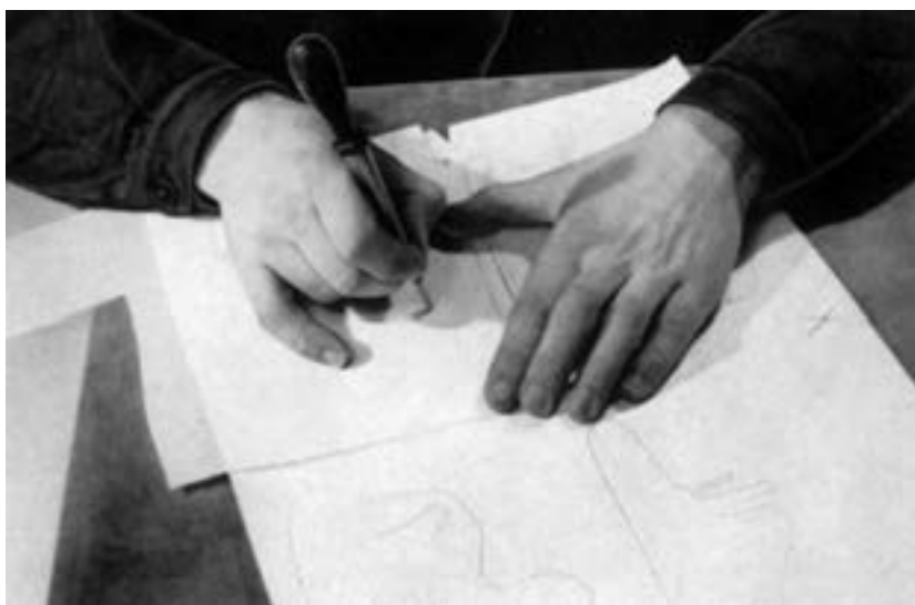
شکل ۲۳-۴- بریدن تکه جهت زیرسازی با تیزبُر (کاتر)
