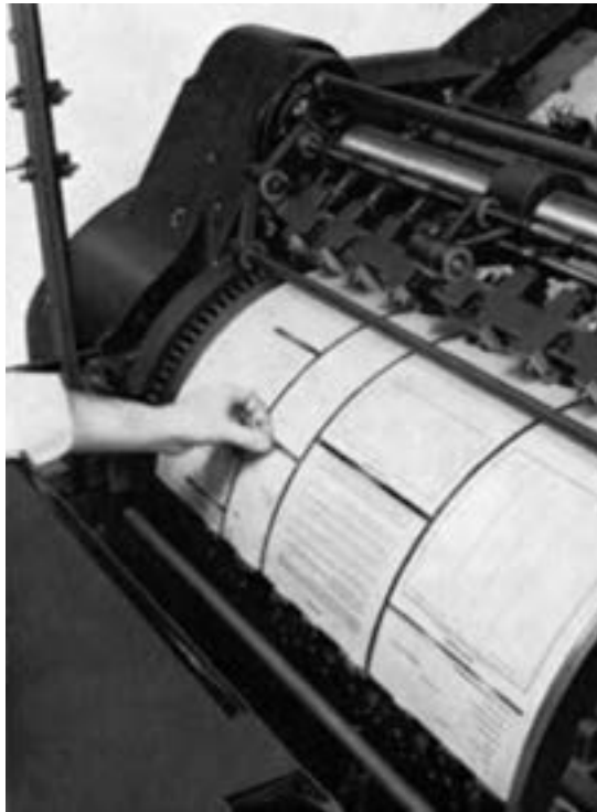
شکل ۴-۴۲- پرفراژ طولی و عرضی در یک مرحله
