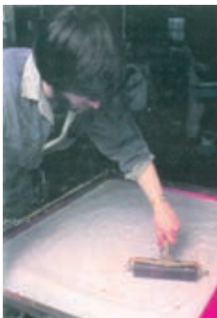
شکل ۱۱-۱۹- عملیات انتقال استنسبیل به سطح توری را نشان می دهد. پس از انتقال، حدود دو ساعت برای خشک شدن توری وقت لازم است تا بتوان ورقه پشت استنسبیل را جدا کرد.
