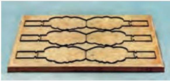
شکل (۳-۱۴) یک نمونه قالب برای فرم غیرهندسی
