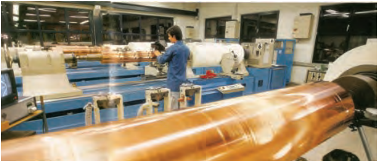
شکل (۳-۲۲) حکاکی روی سیلندر با هلیوکلیشوگراف
