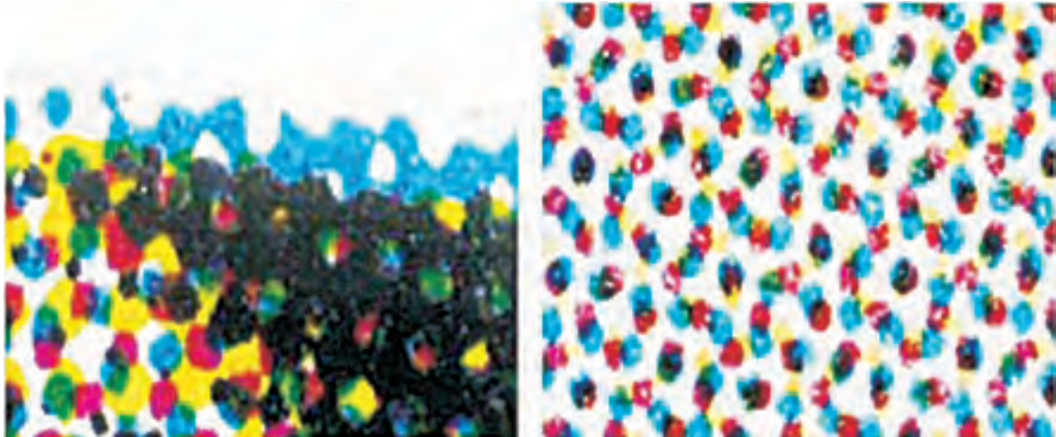
شکل (۶-۱) ساختار نقاط در فرآیند چاپ
