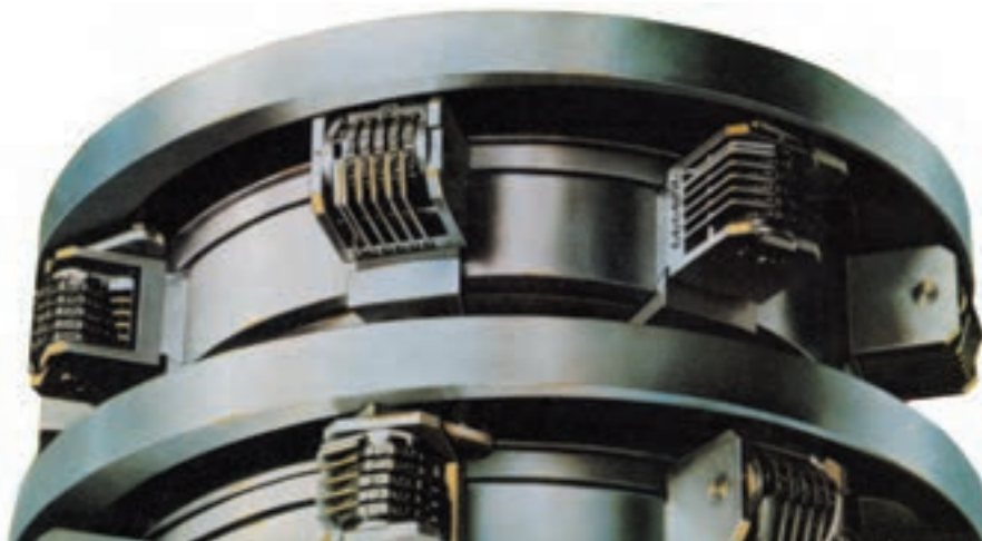
شکل ۴-۳۹- قرقره های دستگاه نمراتور مرکزی با شماره زن های افقی یا عمودی بسته شده
