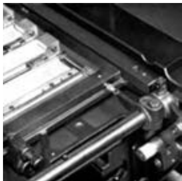
شکل ۳۷-۴- میله ضربه‌زن برای دستگاه‌های شماره‌زنی افقی
