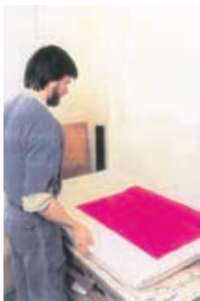
شکل ۱۱-۱۷- سخت کردن فیلم فتواستنسیل (بعضی از انواع فتواستنسیل نیاز به سخت شدن در این مرحله دارند و برای مدت یک دقیقه در وان پری اکسید هیدروژن قرار می گیرند. این عمل باعث سفت تر شدن لایه ژلاتینی آنها می شود).
