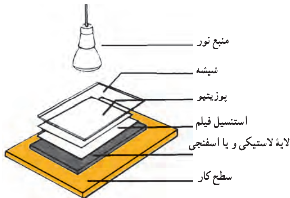
شکل ۱۲-۱۱- روش نوردهی استنسیل فتوکپی غیرمستقیم
