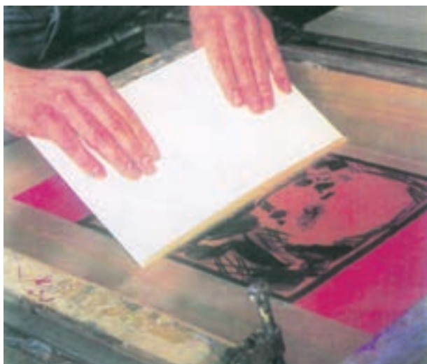
شکل ۵-۱۱- کشیدن صمغ عربی به درون توری با استنسیل توش
