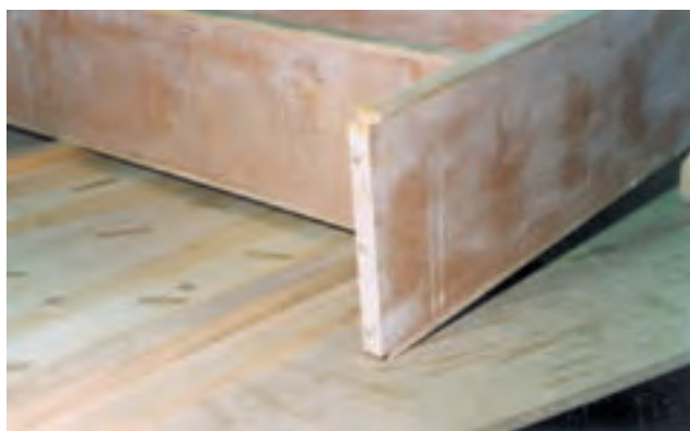
شکل ۱۶- جاسازی دویل در نو بدنه برای اتصال به کلاف زیر صفحه میز
