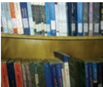
شکل ۵-۶ - طبقه قفسه کتاب پس از چیدن یک ردیف کتاب از حالت خط صاف به قوس تغییر شکل پیدا کرده است.
