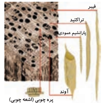
شکل ۱۱-۳- جایگاه رطوبت اشباع در دیواره سلولی پره چوبی (اشعه چوبی)
