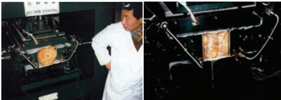
شکل ۲-۵ و ۳-۵ نشان دهنده پرس چوب طبیعی (ماسیو) برای کاهش حجم و افزایش جرم مخصوص در آزمایشگاه
