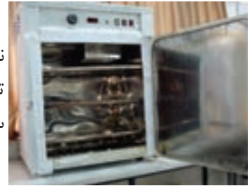
شکل ۱۷-۳- اتو برای خشک کردن نمونه های چوبی در آزمایشگاه
