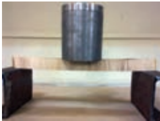
شکل ۷-۱۵- نمونه چوب صنوبر قرار داده شده تحت بار خمشی متمرکز، جهت الیاف عمود بر جهت طولی نمونه می‌باشند.
