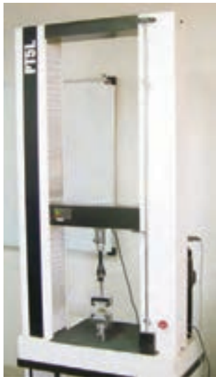
شکل ۱۱-۶، یک نمونه دستگاه مکانیکی کشش و فشار (تستینگ)، ظرفیت این دستگاه در حدود یک تن و انتقال نیرو از موتور به بخش متحرک به وسیله میله مارپیچ می‌باشد.
