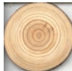
شکل ۴-۱۳- پهنای دایره سالیانه و نسبت چوب بهاره به تابستانه در چوب سرخ‌دار
