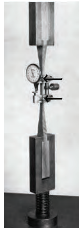
شکل ۲۴-۶، کرنش سنج نصب شده به نمونه چوبی در حال کشیده شدن
